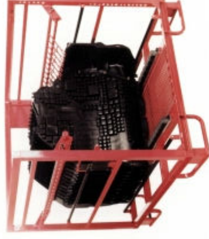
Paleta na prepravu krytov motorového priestoru
